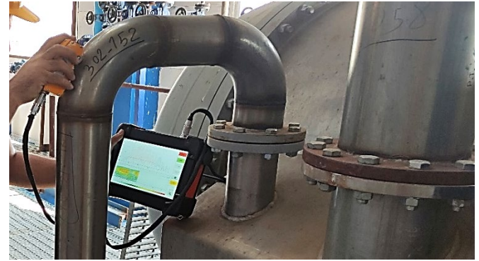
اسکن خوردگی زانویی، محل های اتصال و جوشکاری
