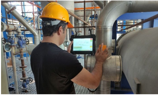
استفاده از روبشگر آلتراسونیک خوردگی جهت اسکن اجسام فلزی و غیرفلزی
