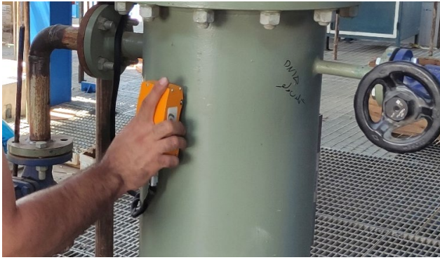
اسکن التراسونیک خوردگی لوله های تحت فشار
