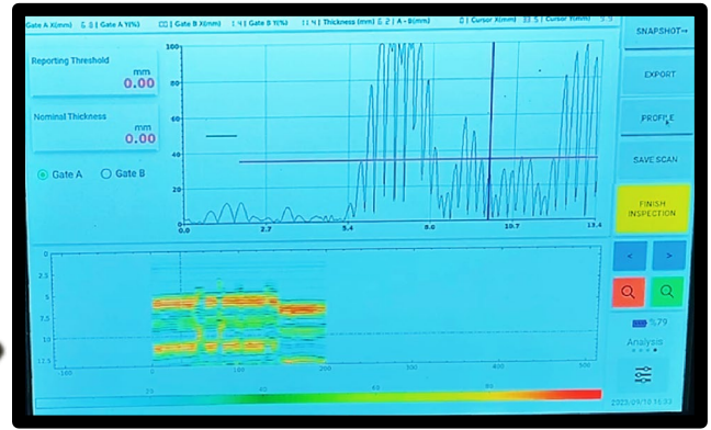
شکل پالس دریافتی از اسکن سطح داخلی لوله
