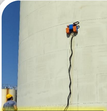
طراحی و ساخت اسکنر پایش خوردگی نیمه اتومات مخازن تحت فشار مرتفع و سیستم پایش خوردگی آنلاین آلتراسونیک پالایشگاهی و پتروشیمی
