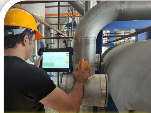
طراحی و ساخت دستگاه پرتابل، تست و کنترل میزان خوردگی مدل راقب با تکنیک جدید چرخ و پراب
