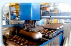
سیستم تست اتوماتیک مخازن CNG
