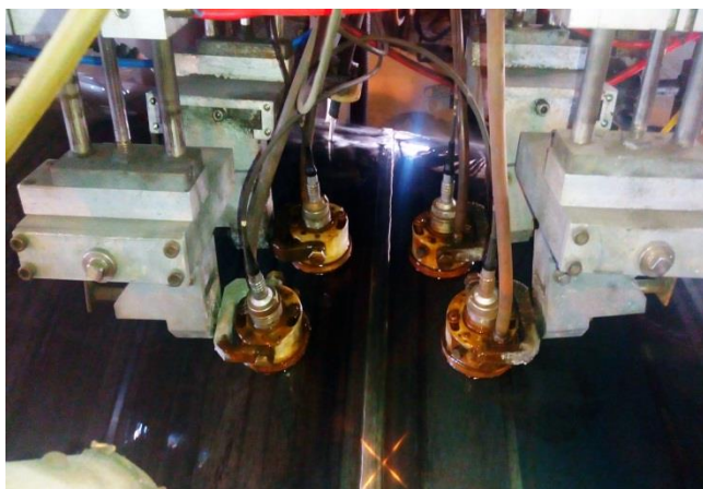
اسکن اتوماتیک جوش لوله های اسپیرال با دستگاه اتوماتیک شرکت پژواک رایان
