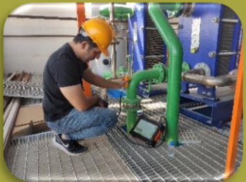
روشگر التراسونیک بازرسی خوردگی (راقب)
